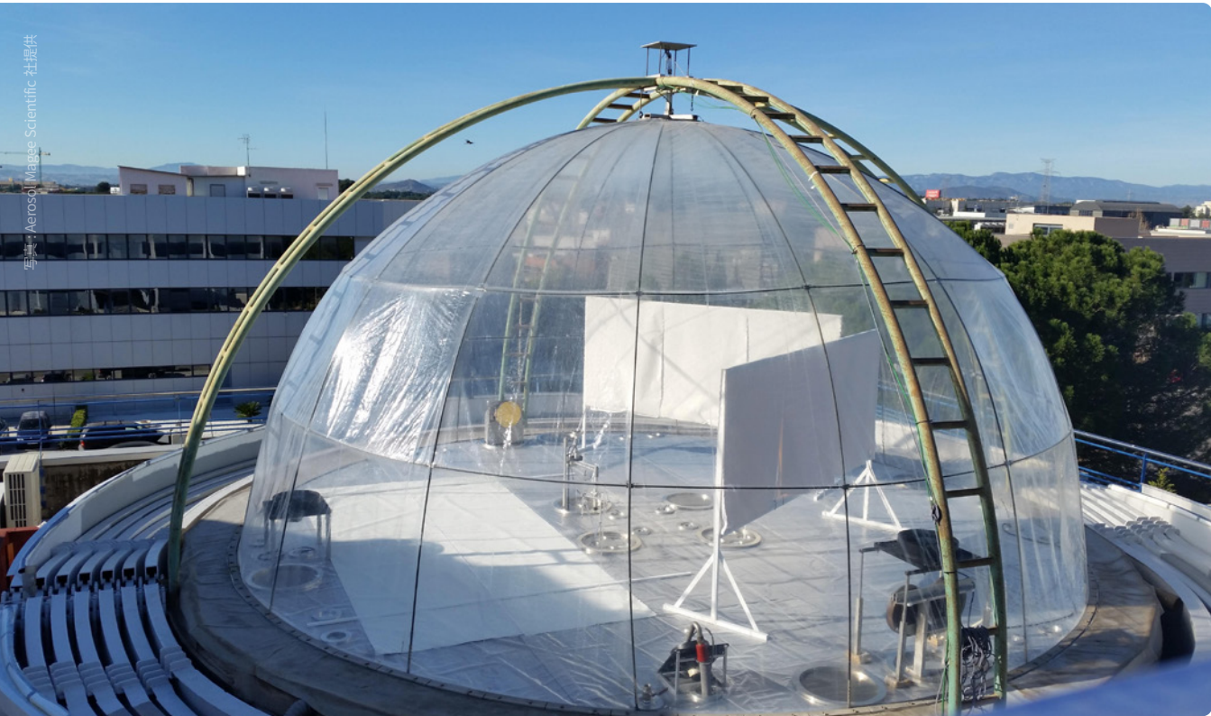
大気汚染、大気汚染物質の影響、森林研究、気象学、気候学の研究のための主要な国際的屋外シミュレーションチャンバーであるスペイン、バレンシアの EUPHORE での新しい Aerosol Magee Scientific 社の機器のテスト。
