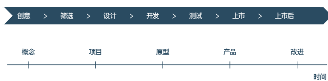
图4: 新产品开发流程与开发中的产品的成熟度
