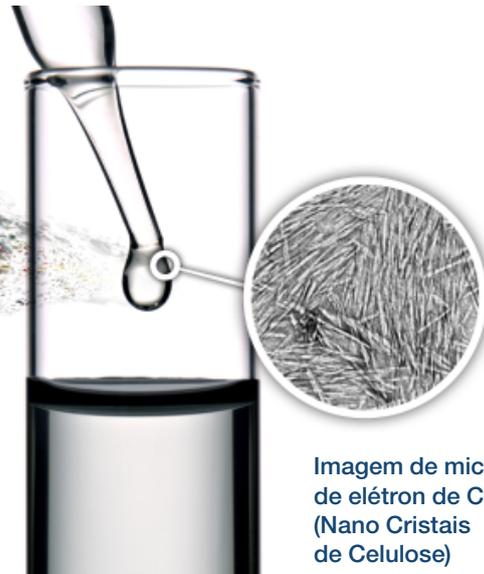
Imagem de microscópio de elétron de CNC (Nano Cristais de Celulose)
