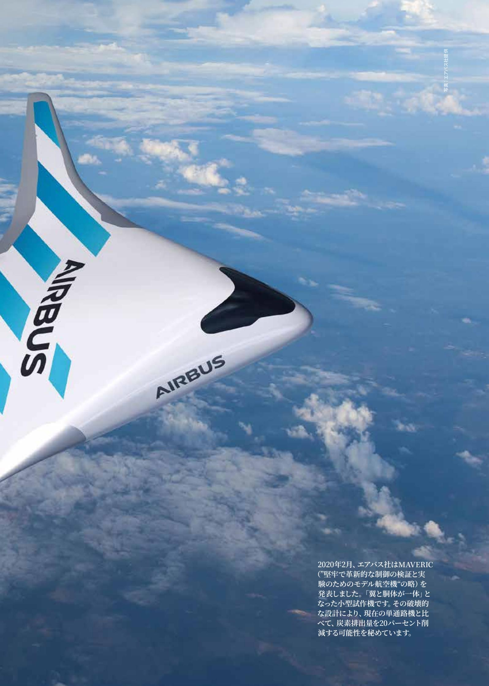
2020年2月、エアバス社はMAVERIC（“堅牢で革新的な制御の検証と実験のためのモデル航空機“の略）を発表しました。「翼と胴体が一体」となった小型試作機です。その破壊的な設計により、現在の単通路機と比べて、炭素排出量を20パーセント削減する可能性を秘めています。
