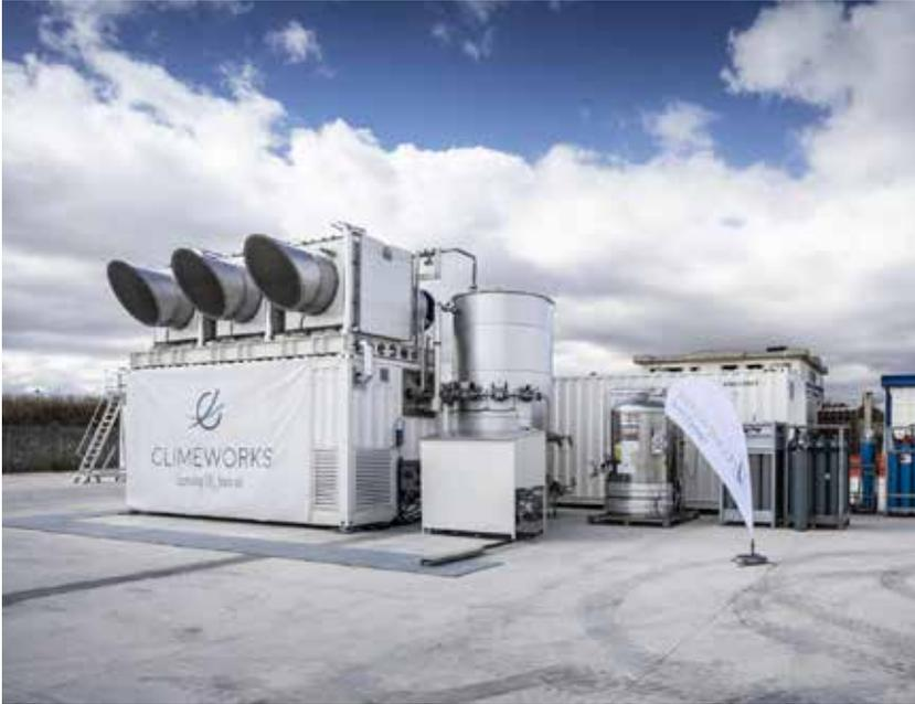
スイスを拠点とする企業、Climeworksは、世界で初めて大気から二酸化炭素を除去する商用の直接空気回収テクノロジーを開発しました。それぞれのコレクターは小型車のサイズで、重ねることで任意のサイズのプラントをつくることができます。
