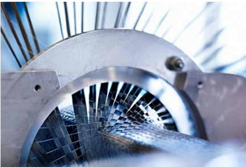
エアバス社は、アルミニウムより軽量で、鉄より強く、これら両方の金属よりも耐食性に優れている炭素繊維強化プラスチック（Carbon Fibre Reinforced Plastic、CFRP）などの様々な新しい複合材料を検討しています。航空機の部品は、炭素繊維を所定の位置にまとめるハイテク織機を通じて供給されます。
