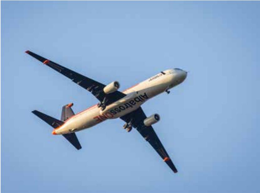
羽ばたくことなく数百キロも飛行できる伝説的なアホドリからインスピレーションを受けたエアバス社のAlbatrossOne試作機は、自由に羽ばたく翼端を飛行中に試用した最初の航空機です。これにより、抗力を低減し、乱気流や突風の影響に対抗でき、将来的にはより軽い航空機を作ることができます。
