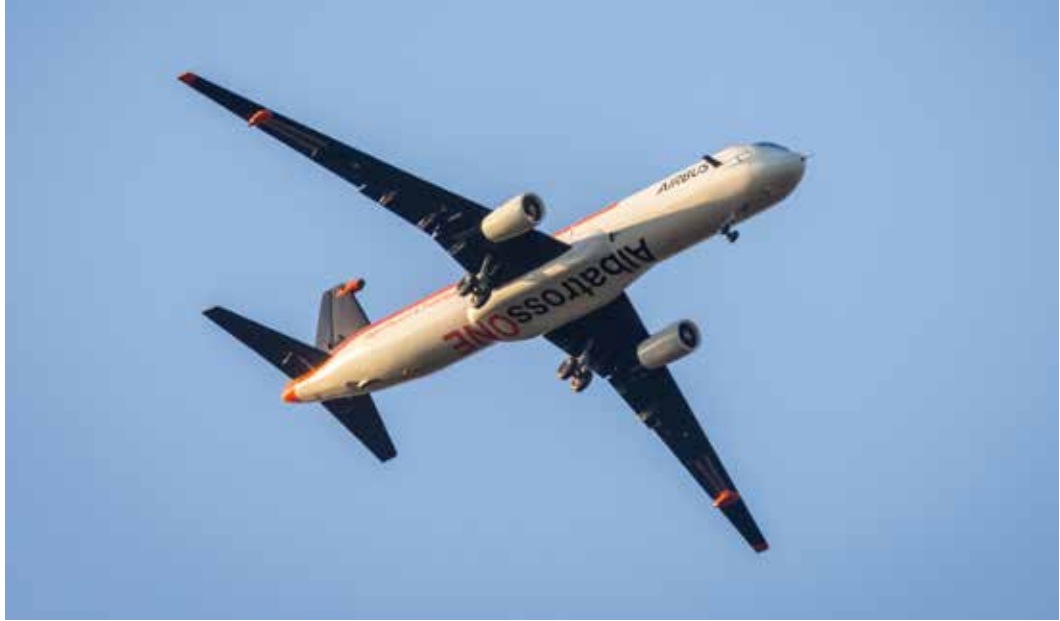
طائرة AlbatrossOne النموذجية لشركة إيرباص - المستوحاة من طائر القطرس البحري الأسطوري - الذي يستطيع الارتفاع مئات الكيلومترات في السماء دون أن يرفرف بجناحيه - هي أول طائرة تجريبية مزودة بطرف جناح مرفرف تلقائياً. ويمكن لهذه التقنية أن تقلل من قوة السحب وآثار الاضطرابات الجوية وهبوب الرياح وأن تجعل الطائرات أخف وزناً في المستقبل.
