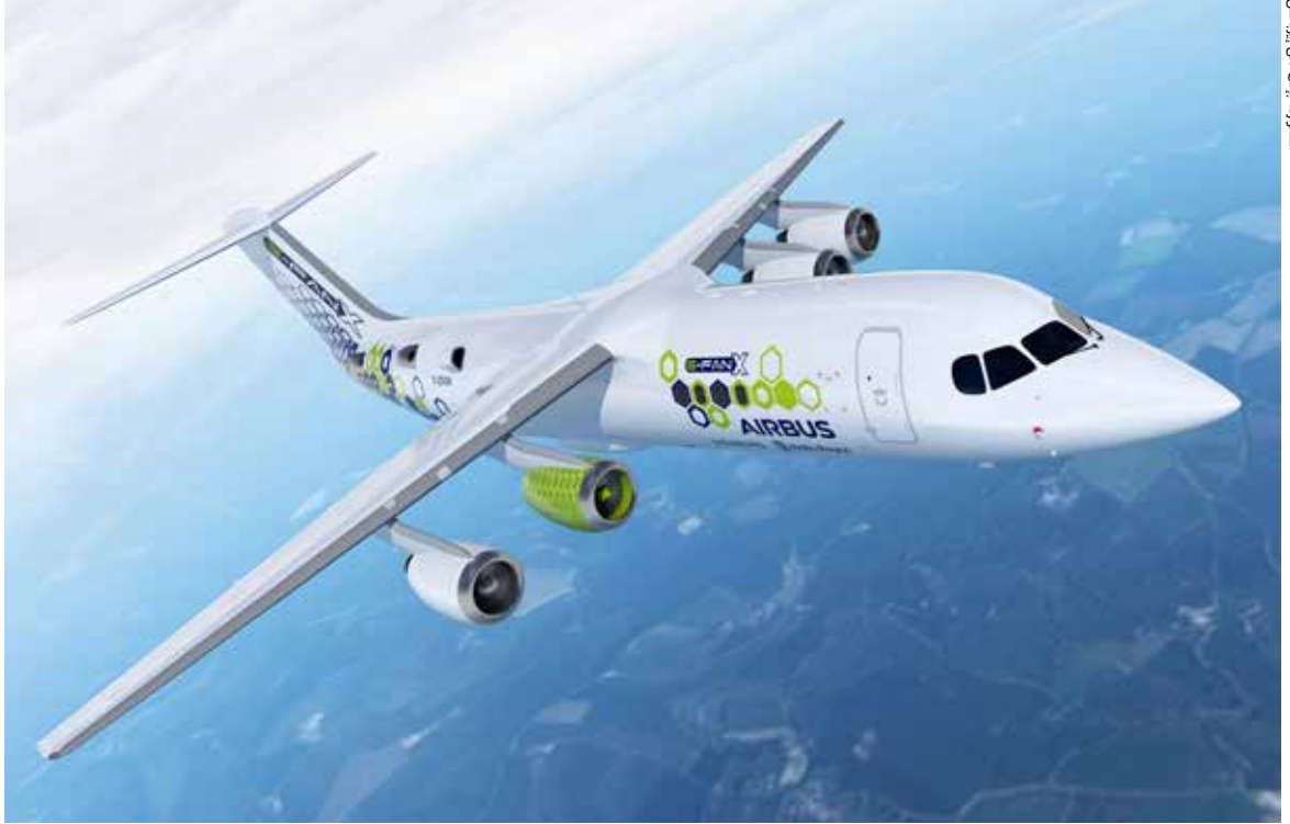
ما انفكت إيرباص تطور أنظمة كهربائية وكهربائية هجينة منذ عام 2010، وأطلقت في نوفمبر 2017 الطائرة النموذجية الكهربائية الهجينة المصغرة E-FAN X بالشراكة مع رولز رويس.
