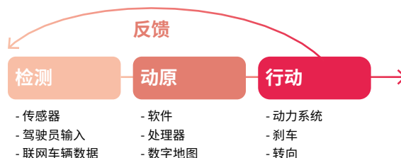
图 3.1 任何计算机自动化系统的三个基本功能组件
