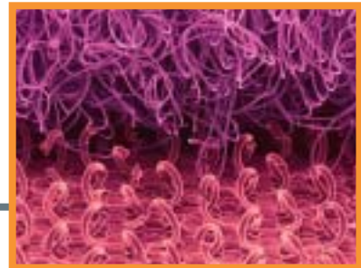
Imagen micrográfica de barrido electrónico teñida de VELCRO® cerrado. © Dee Breger, Drexel University
